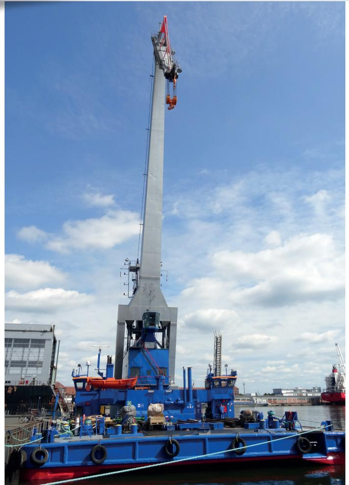
Der Schwimmkran kann Lasten von bis zu 100 t heben, auf dem Wasser transportieren und präzise absetzen. Vorrangig von Bremen bis Bremerhaven ist der Kran entlang der Weser einsetzbar und kann dort – flexibler als ein Landkran – jegliche Art von Schwergut und
