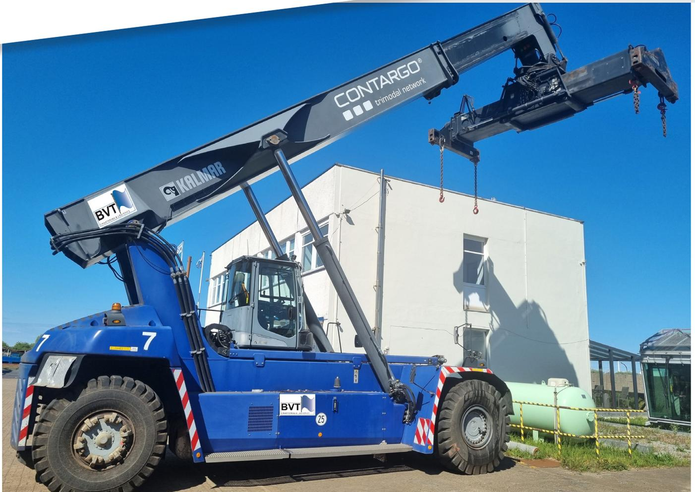
Der KALMAR DRG 420 ist ein leistungsstarker und vielseitiger Reachstacker, der für den anspruchsvollen Umschlag von Containern und Schwerlasten entwickelt wurde. Mit seiner hohen Tragfähigkeit, dem robusten Teleskop-Hubarm und modernster Sicherheitstechnik ermöglicht er präzises und effizientes Arbeiten – selbst
